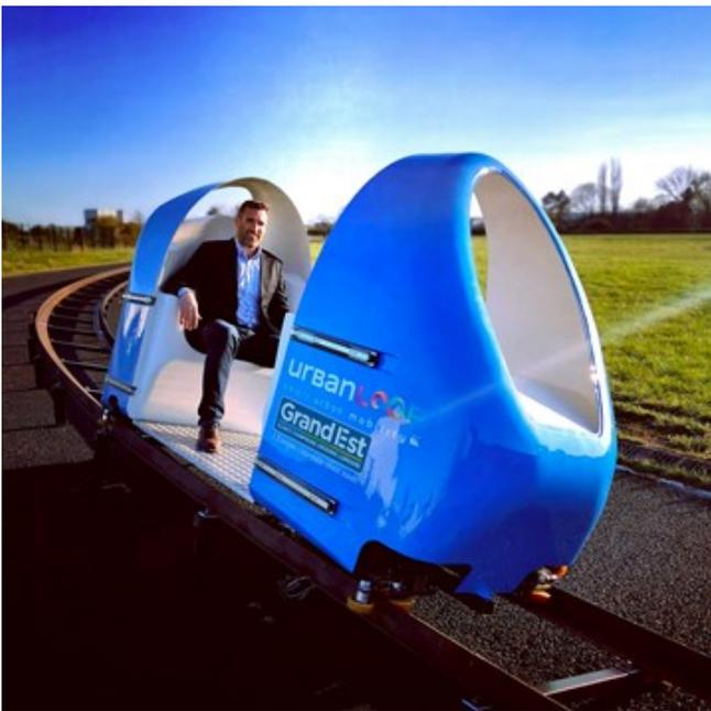
**Description du projet:** Déploiement de flottes de capsules autonomes sur rail pouvant transporter 1 ou 2 personnes, dont PMR et vélo. Les capsules avancent à 60km/h, elles sont 100% électriques, sans batterie et à très faible consommation. Le réseau dessert plusieurs stations intermédiaires en dérivation de la ligne principale ce qui permet à l'utilisateur de voyager sans attente, sans arrêt intermédiaire et sans correspondance.
