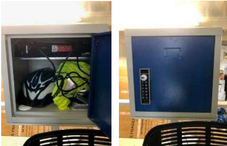
*Batterie VAE en charge et effets de cyclistes – passe-cloison permettant de laisser son chargeur dans le casier fermé et recharger directement la batterie sur le VAE.*
